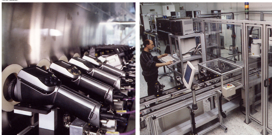
図 27.5 左: 気候室での赤外線カメラの試験。右: カメラテストおよびキャリブレーション用ロボット
