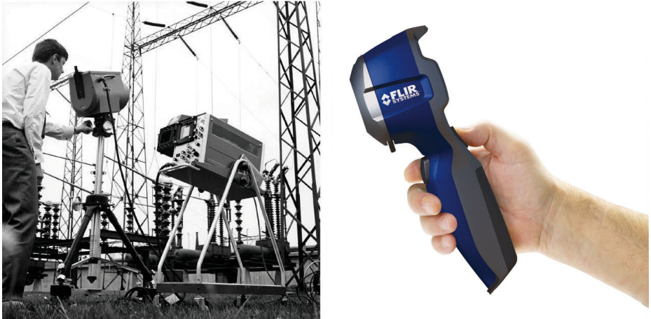
図 27.2 左Thermovision® Model 661、1969年発売カメラの重量は約25 kg (55 lb.)、オシロスコープは20 kg (44 lb.)、三脚は15 kg (33 lb.)です。オペレータは220 VACジェネレーターセットと、液体窒素の入った10 L (2.6 USガロン) 容器も必要です。オシロスコープの左側には、ポラロイドのアタッチメント (6 kg/13 lb.)があります。右: FLIR i7、2009年発売重量:0.34 kg (0.75 lb.)、バッテリーを含む
